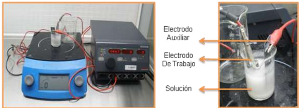
Figura 7. Montaje realizado para la electrodeposición catódica.
