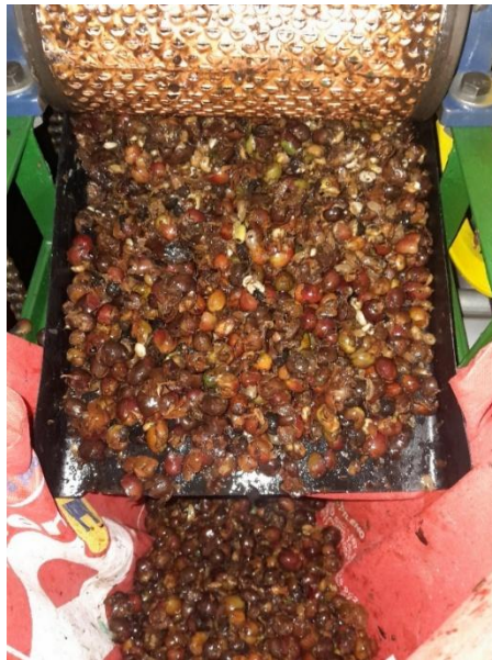
Figura 67. Pulpa de café cereza después del proceso de descerezado.
