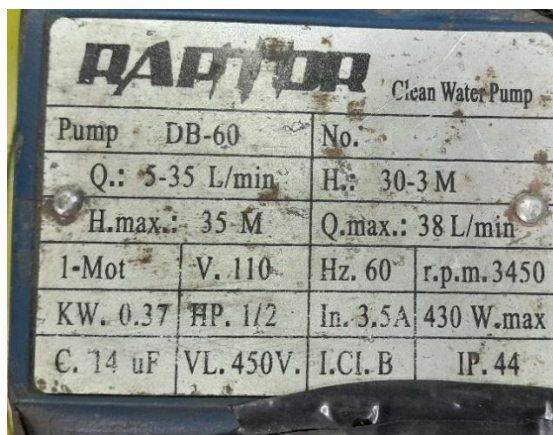
Figura 72. Placa de información de la Bomba.
