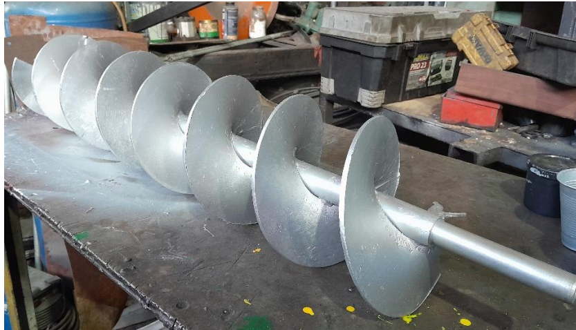
Figura 63. Tornillo sin fin fabricado.
