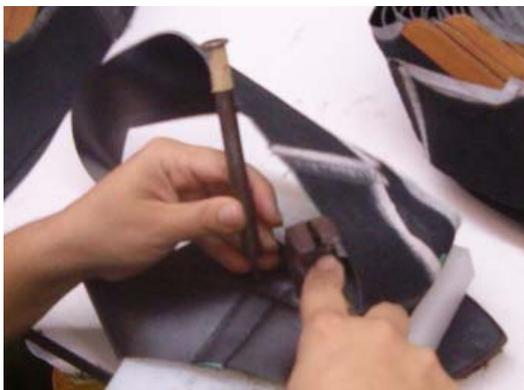
Los perforadores son herramientas de un solo mango para trabajos de precisión, no requieren de fuerza por lo tanto el diámetro del mango debe estar entre 6 y 12 mm. La herramienta es sostenida por el pulgar y los otros dedos. El diámetro es de 1cm.
