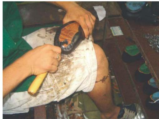
Fig. 127. Cortar sobrante de forro del corte
