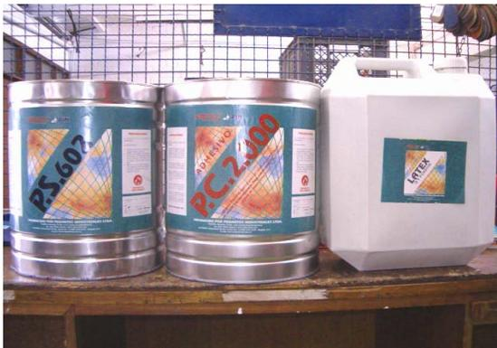
Fig. 34. Pegante amarillo PC.2000 para armar. Caucho PS.602 para abollonados, abrir costura, y pagar forros sintéticos. Látex para doblar, pegar punteras y forros en badana. Marca ARTECOLA.
