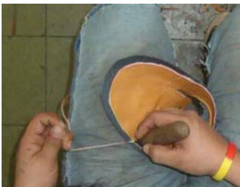
Fig. 128 Nivelar plantillas de odena a la horma
