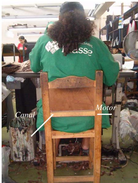
Fig. 78. Presión del canal de residuos sobre el muslo de la operaria.
