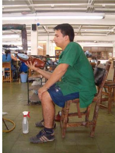
Fig. 122. Operación quitar arrugas a punteras y talones. Vista frontal.
