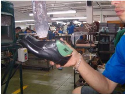
Otra actividad es desarrugar el cuero en la capellada y el talón del zapato, mediante el calor producido por un motor eléctrico y una resistencia. El Índice de temperatura WBGT que alcanza a recibir la mano, cara y piernas del operario es de 50.16°C.
