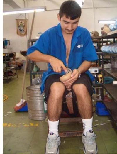
Figura 118. Operación de roñado (Desbaste de cuero). Vista lateral
