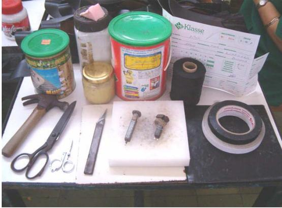
Fig. 32. Herramientas: martillo, perforadores, tijeras, cuchilla. Plancha para martillar y una base para perforar. Pegantes, cinta, hiladillo, hilo para tejer y goma para limpiar el pegante del corte.
