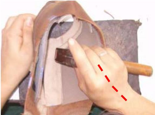
Herramienta de un solo mango utilizada para presionar a través de los golpes las piezas de cuero que han sido unidas con adhesivo. Debido a que se requiere de fuerza el diámetro del mango debe estar entre 31mm 50 mm. Se sujeta con los cuatro dedos y el pulgar rodeándolo.
