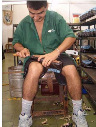
Fig. 120. Operación: Desarrugar el zapato por medio de calor. Vista lateral.
