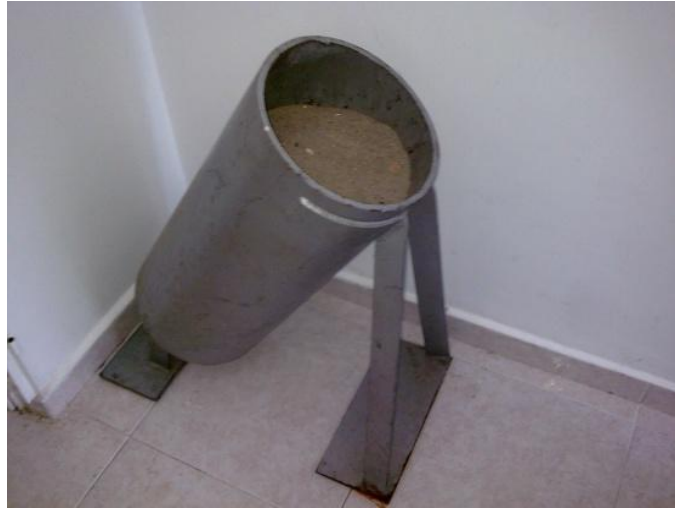
Figura 11. Tubo de arena para limpieza de armas
