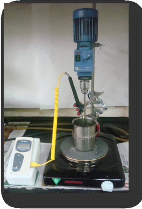
Fotografía 1. Montaje para la modificación de asfalto
