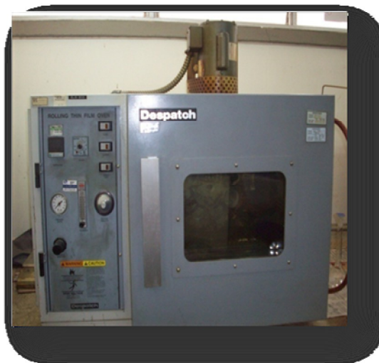
Fotografía 8. Método de ensayo en el horno de lámina asfáltica delgada en movimiento (INV E - 720 - 07)
