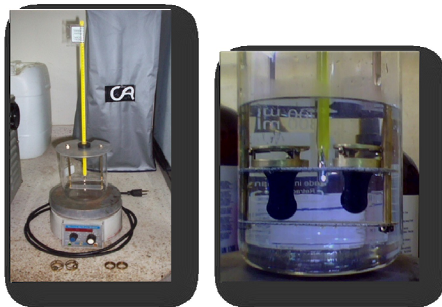
Fotografía 6. Método de ensayo para la determinación del punto de ablandamiento de materiales bituminosos (Aparato de anillo y bola) (INV E - 712 - 07)
