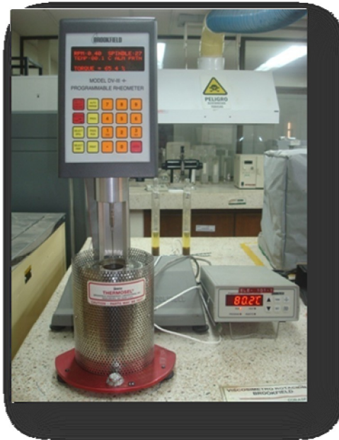
Fotografía 7. Método para determinar la viscosidad del asfalto empleando el viscosímetro rotacional (INV E - 717 - 07)
