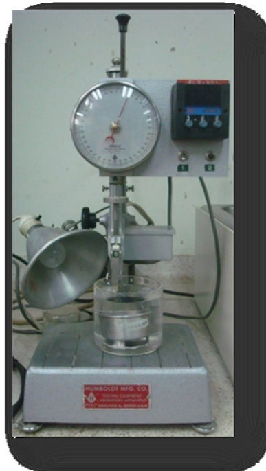
Fotografía 5. Método de ensayo para la determinación de penetración de los materiales asfálticos (INV E 706-07)
