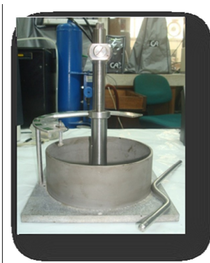
Fotografía 9. Método de ensayo para la determinación de la recuperación elástica por torsión de asfaltos modificados (INV E - 727 - 07)
