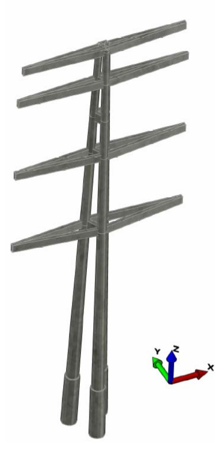
Figura 5.2. Estructura en concreto tipo doble circuito vertical con doble cable de guarda y crucetas en concreto
