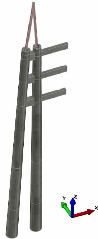
Figura 5.4. Estructura en concreto tipo vertical con cable de guarda, crucetas en concreto y bayoneta metálica
