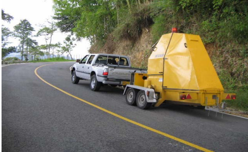
Figura No 9 Deflectómetro de impacto KUAB 50
