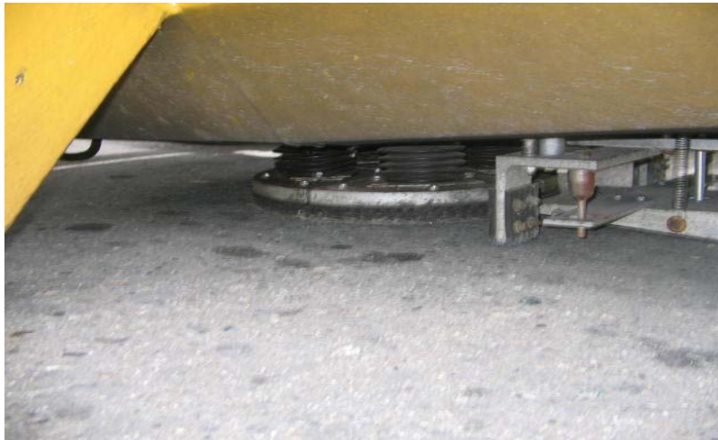
Figura No 10 Sensor de FWD aplicando la carga durante su medición
