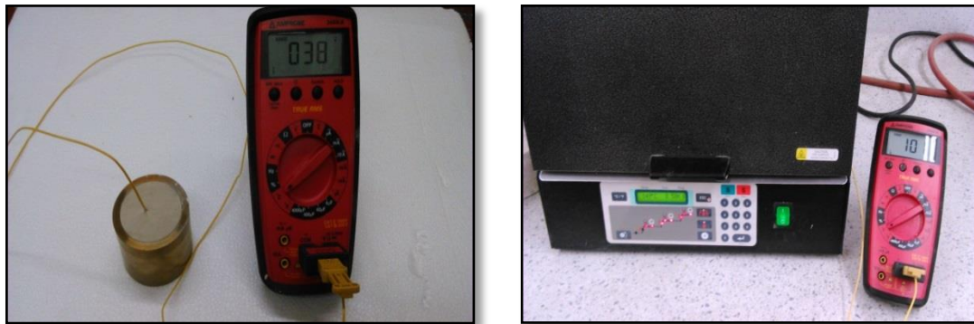
Figura 3. Medida de temperatura de deshidratación del revestimiento durante el tratamiento térmico.
