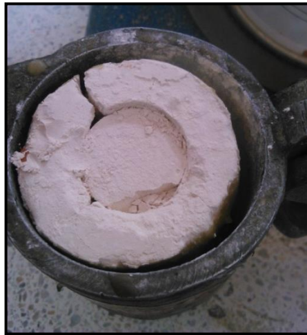
Figura 12. Daño de probeta Mezcla 3.
