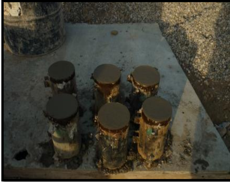
Figura 12. Cilindros para realizar ensayo de resistencia al concreto
