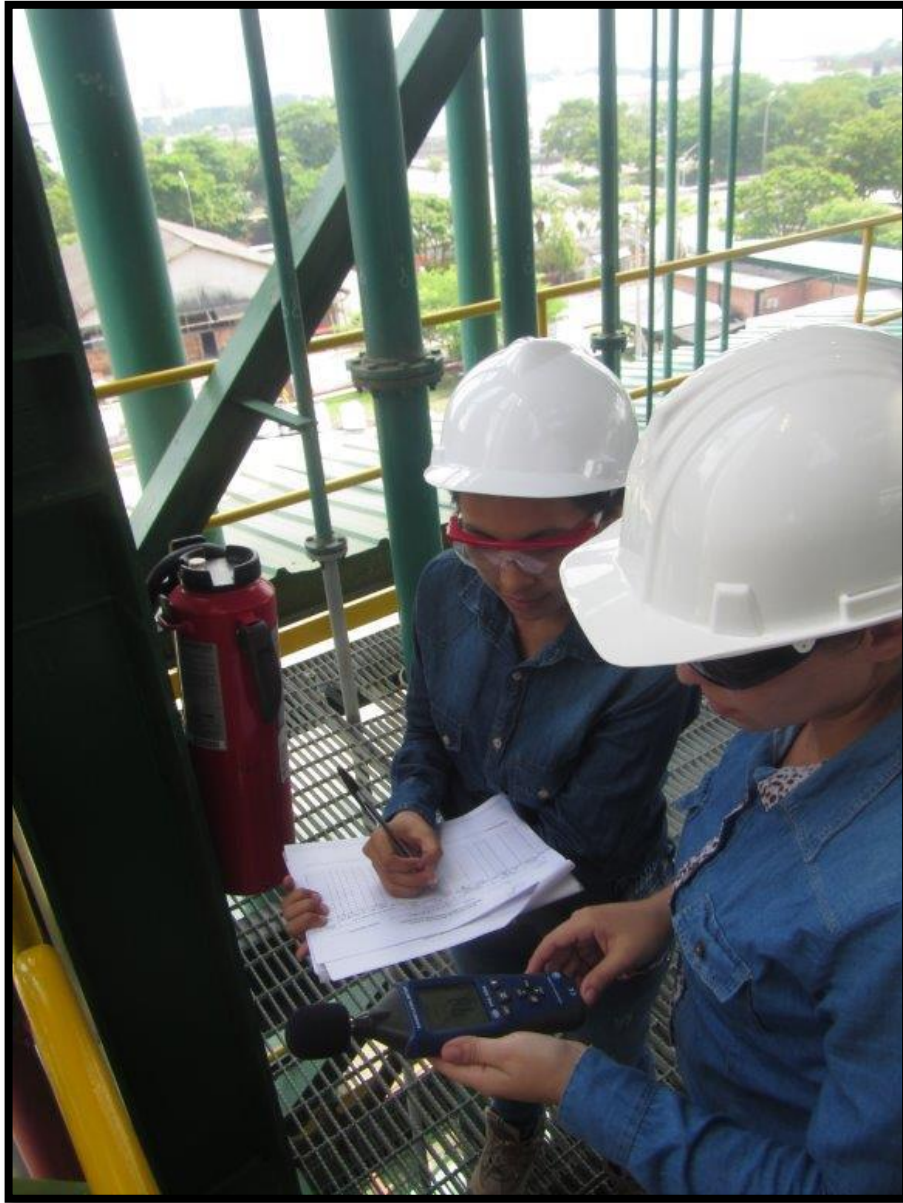
Fotografía que muestra una toma de medición de ruido frente del equipo 68213 de la planta Ecodiesel.
