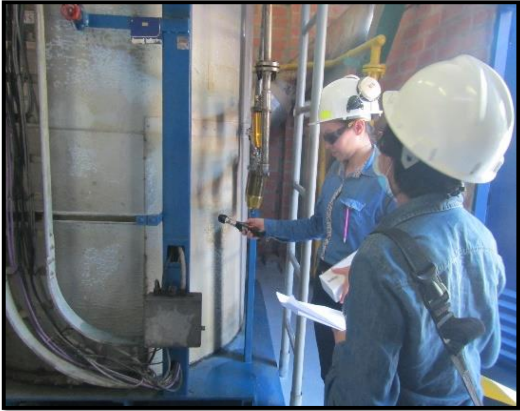
Fotografía que muestra una toma de medición de estrés térmico en el separador 621 de la planta Ecodiesel.
