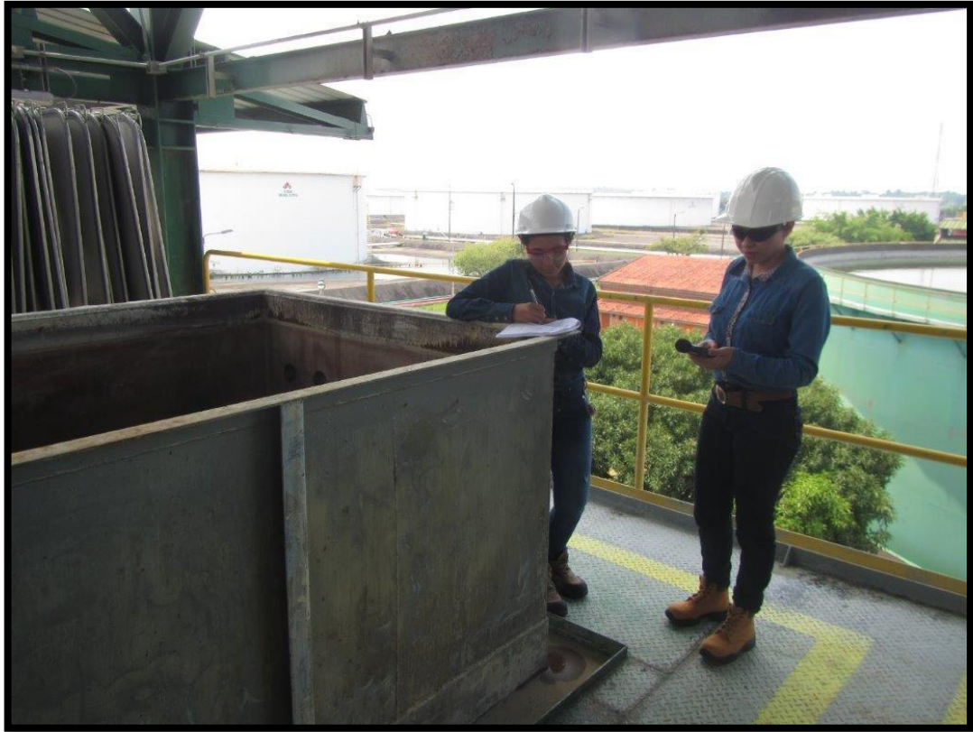
Fotografía que muestra una toma de medición de ruido en lado del equipo oleodina de residuos grasos de la planta Ecodiesel.
