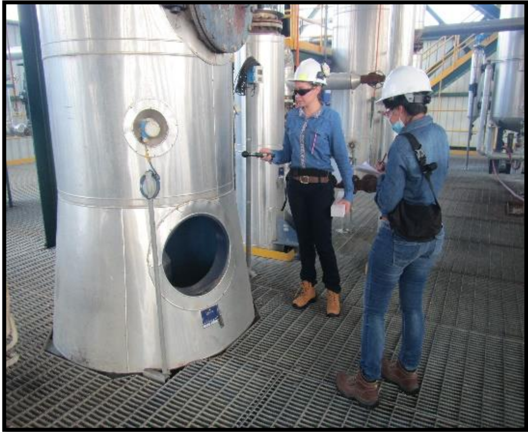
Fotografía que muestra una toma de medición de estrés térmico en la columna de glicerina de la planta Ecodiesel.
