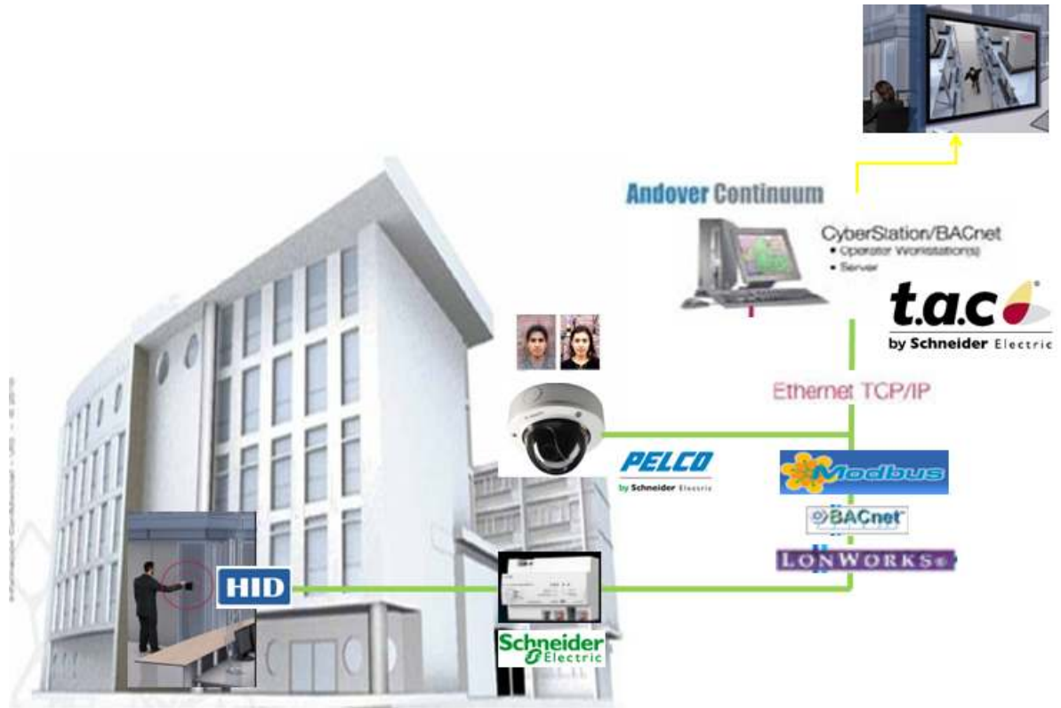
Figura 20. Ejemplo de aplicación inmótica de seguridad para el edificio Eléctrica II
