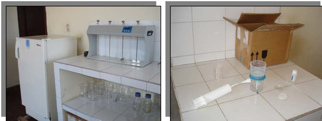
Figura J8. Nevera para conservación de reactivos y quipo para la determinación de coliformes totales.
