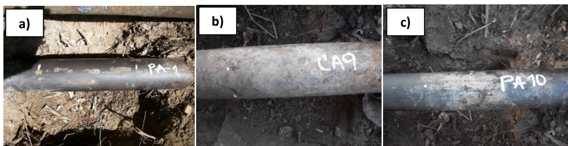
Figura 9. Daños de los apiques a) pérdida parcial del recubrimiento b) pérdida total del recubrimiento y c) degradación
