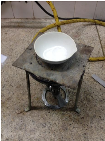
Procedimiento alternativo de descomposición del bicarbonato de sodio para obtener carbonato de sodio
