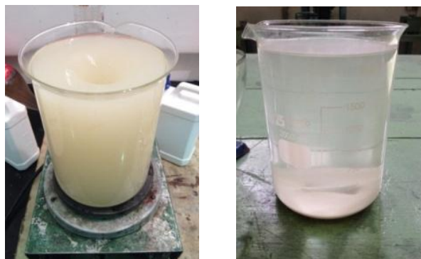
Figura 4: a) Agua de producción en agitación con cal sodada. b) En reposo con precipitado y agitador magnético sumergido.
