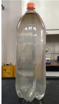
Figura 3: Muestra de agua de producción únicamente filtrada al vacío y próxima a decantar.
