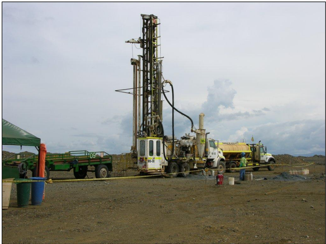
Figura 9. Perforación de circulación reversa (RC)
