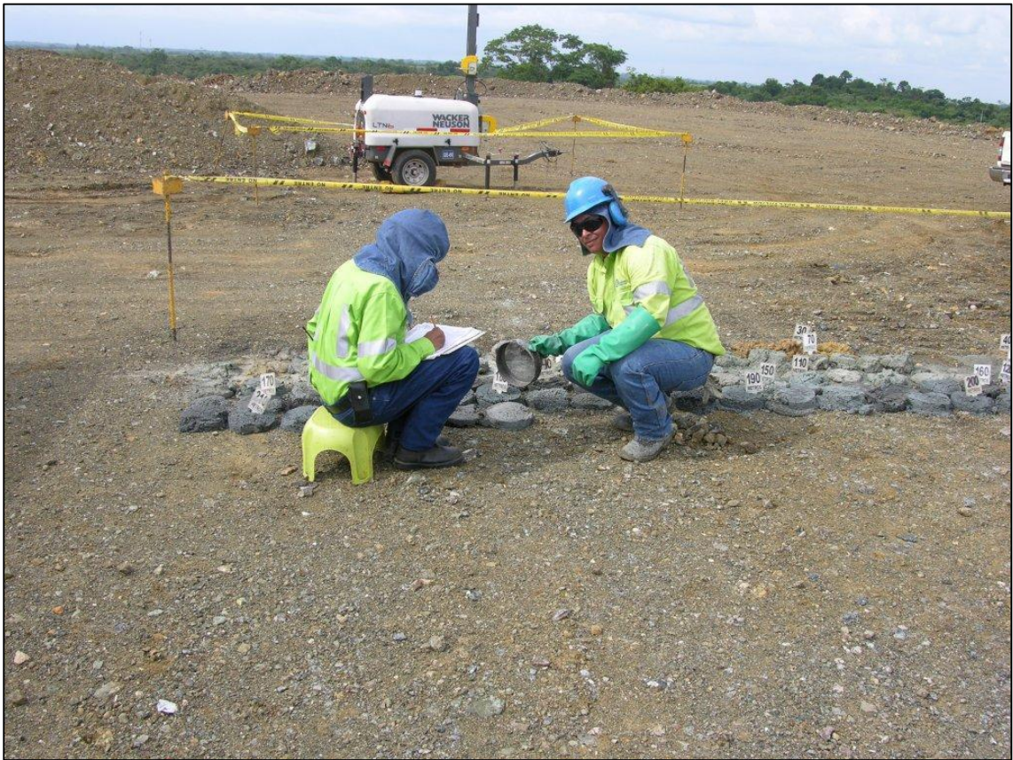
Figura 10. Muestreo de ripios de perforación en intervalos de 2 metros
