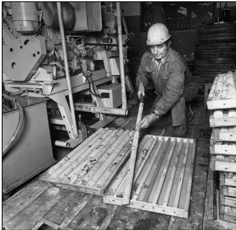
Figura 12. Almacenamiento de núcleos de perforación.
