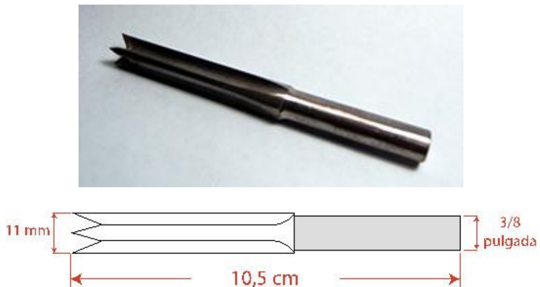
Figura 56. Broca de barreno oscilante hecha a medida.
