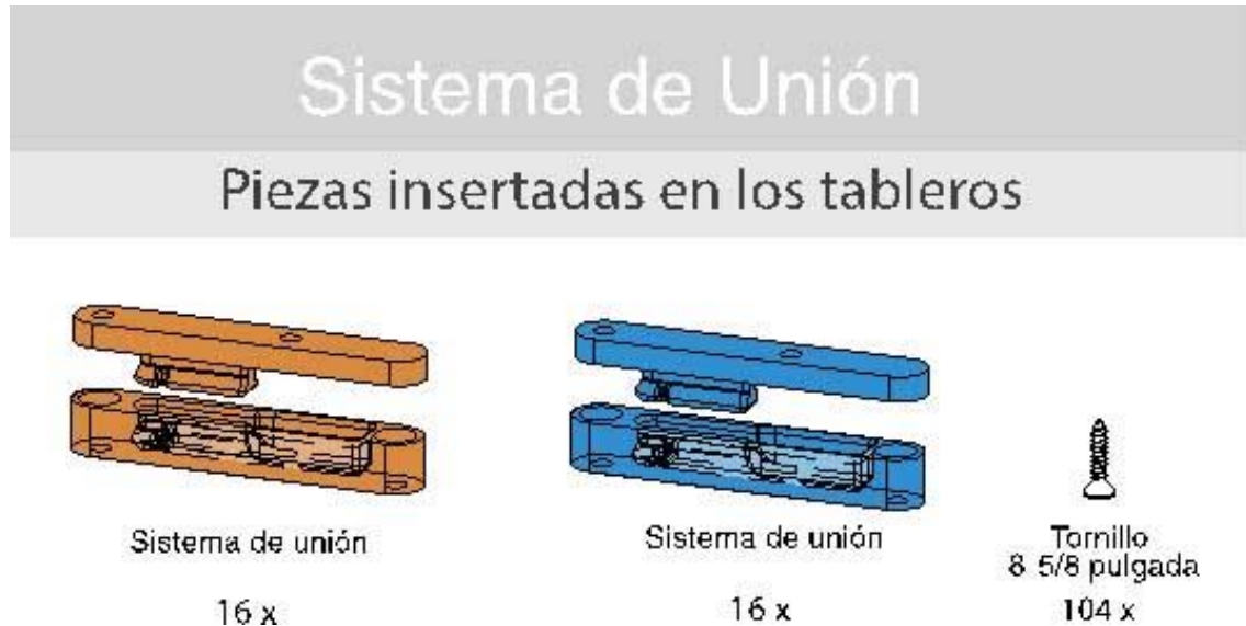
Figura 90. Código de color en piezas del sistema de unión "Duofit".
