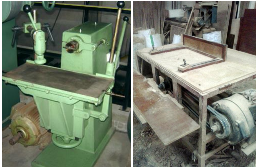
Figura 55. Barreno tradicional de carpintería.
