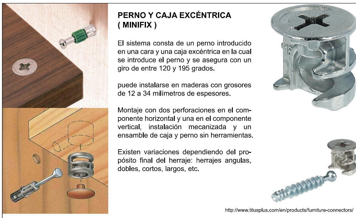
Figura 5. Sistema perno y caja excéntrica (minifix).
