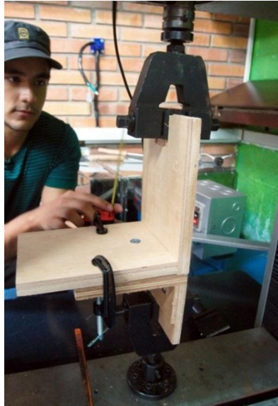
Figura 27. Montaje de tensión en ensamble en "L".
