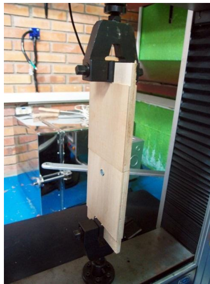
Figura 26. Montaje de Tensión en ensamble continuo.
