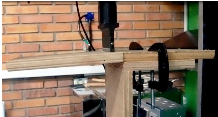
Figura 30. Montaje de cortante en ensamble continuo.
