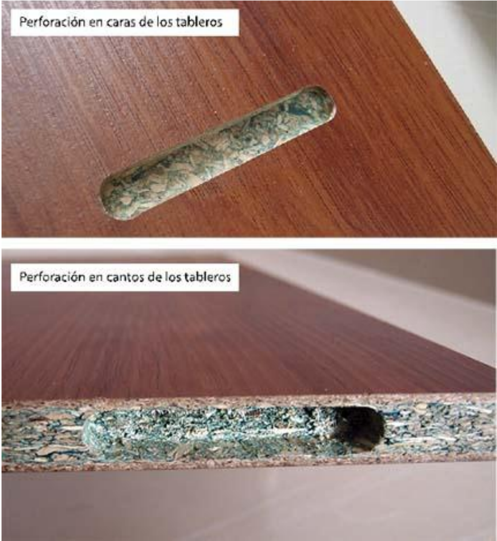
Figura 91. Perforaciones realizadas en los tableros.
