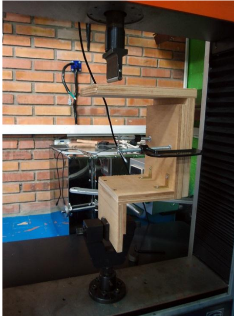
Figura 29. Montaje de flexión en ensamble en "L".
