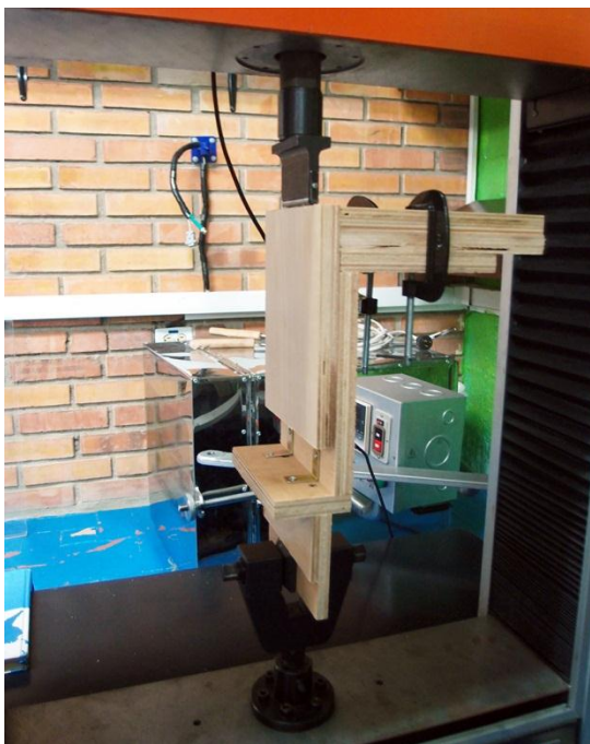
Figura 31. Montaje de cortante en ensamble en "L".
