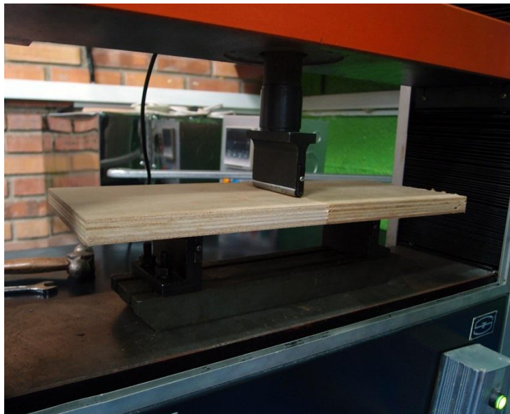
Figura 28.Montaje de flexión en ensamble continuo.
