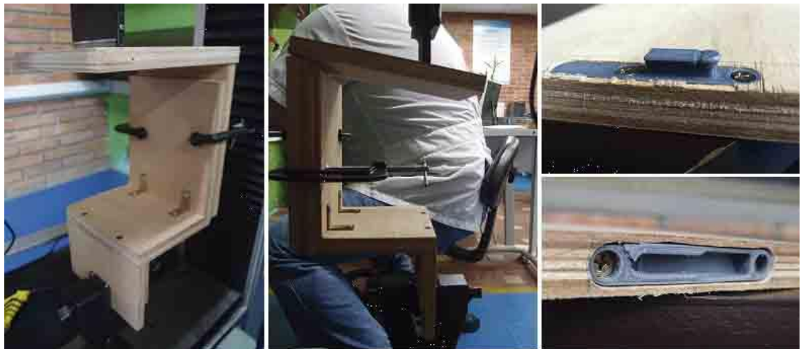
Figura 76. Ensayo de flexión ensamble en L. Prototipos finales
