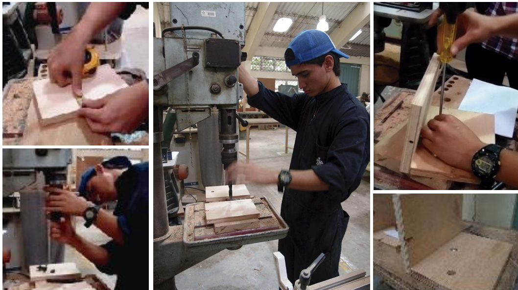
Figura 33. Medición de tiempos. Montaje y ensamblaje del herraje.
