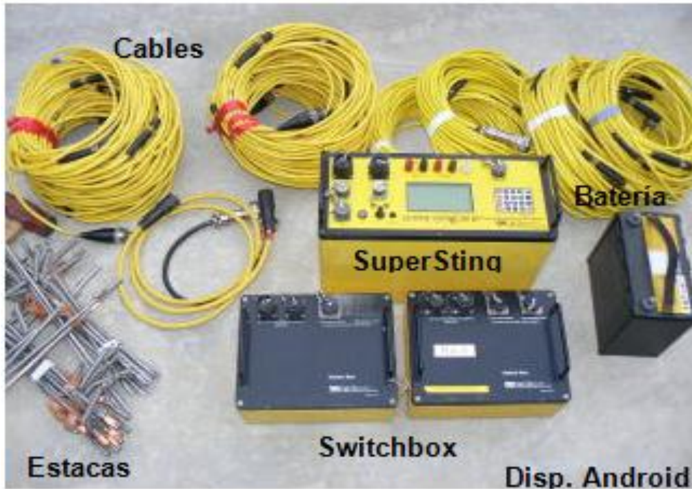
Figura 12. Equipo medidor de resistividad Supersting.
