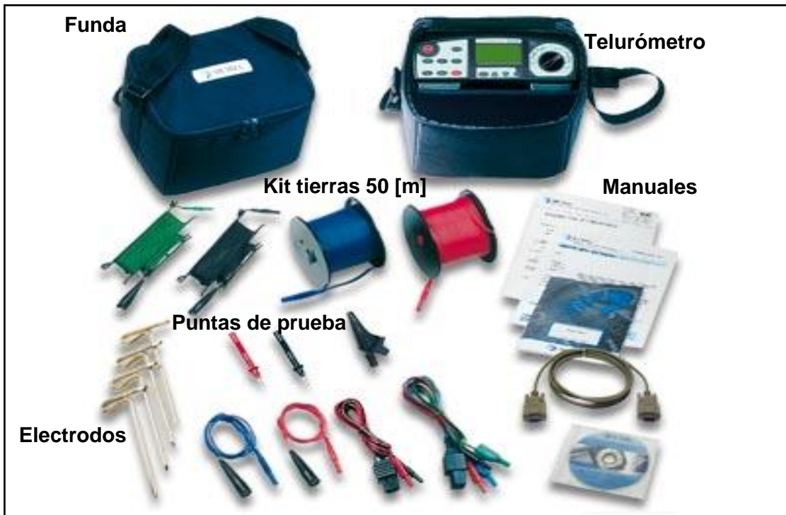
Figura 14. Equipos utilizados para las medidas con el telurómetro.
