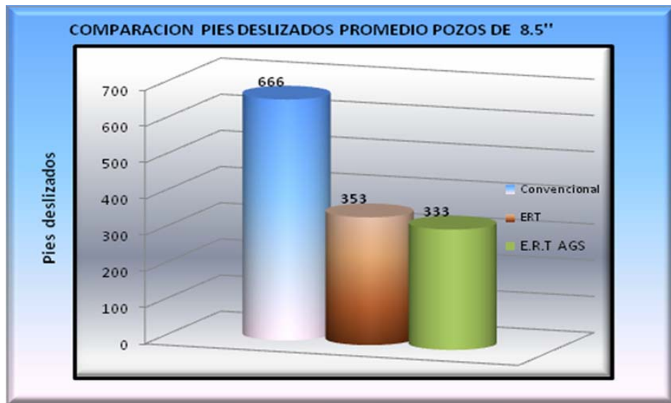
Figura 5.18. Comparación de pies promedio deslizados en la perforación con Motor Convencional, ERT, ERT y AGS.
