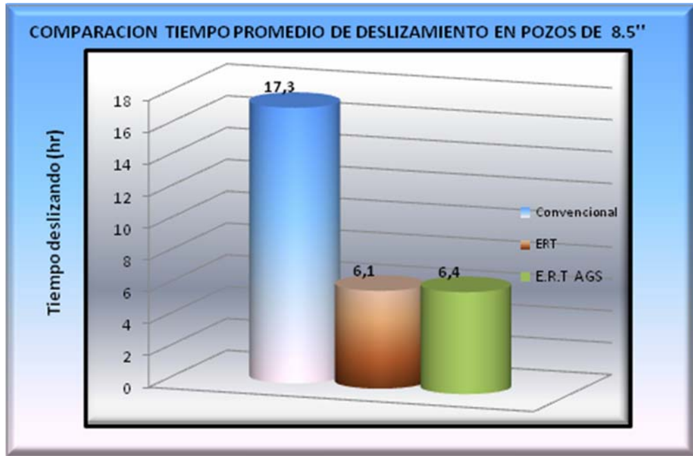
Figura 5.20. Comparación de tiempos promedio de deslizamiento en la perforación con Motor Convencional, ERT, ERT más AGS.
