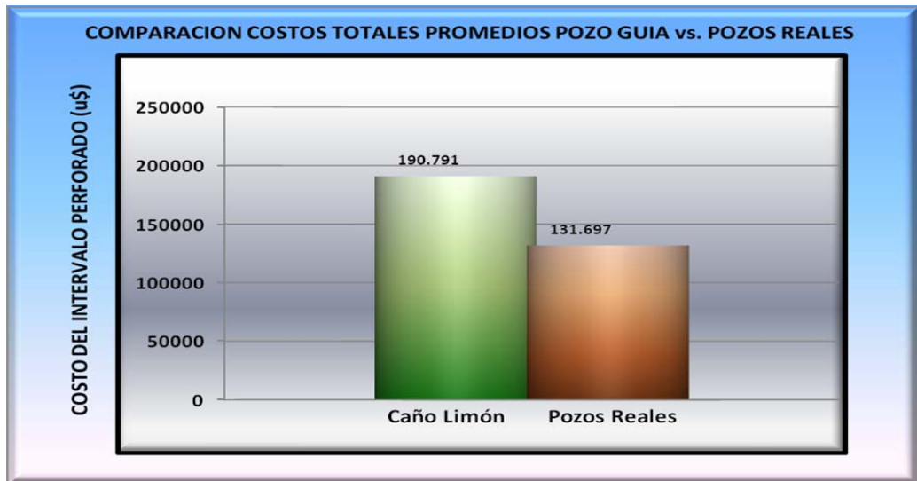
Figura 6.23. Comparación de costo total del pozo Caño Limón vs. costo promedio de Pozos reales perforados con motor ERT pozos de 8 ½ ”.
