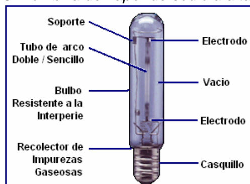
Figura 3. Bombilla de vapor de sodio a alta presión
