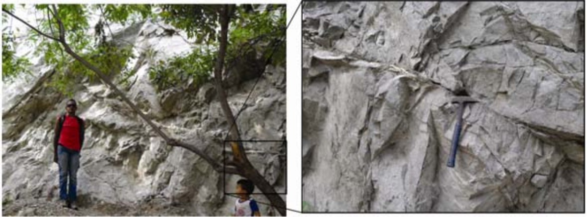
Figura 9. Afloramiento ubicado sobre la vía que de santa Marta conduce a Taganga, donde se observa roca metamórfica de tipo Anfibolita medio a grueso granular, se observa muy diaclasada debido a su reología.
