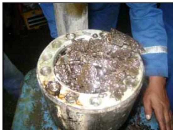
**Figura 6.** Incrustaciones de carbonato de calcio en una bomba
