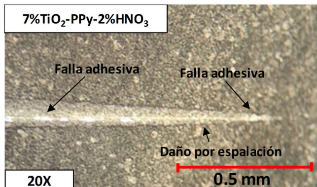
Figura 16. Macrografía del recubrimiento de PPy + 7% p/p TiO 2 sobre el acero AISI- SAE 1020 tratado superficialmente por inmersión en la solución de 2%v/v de HNO 3 después del ensayo de adherencia mediante scratch test.
