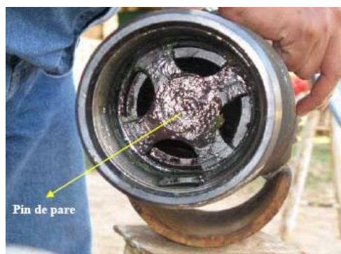
Figura 9. Pin de pare del Niple
