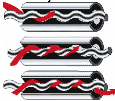
Figura 15. Distribución del flujo a través del elastómero y el rotor
