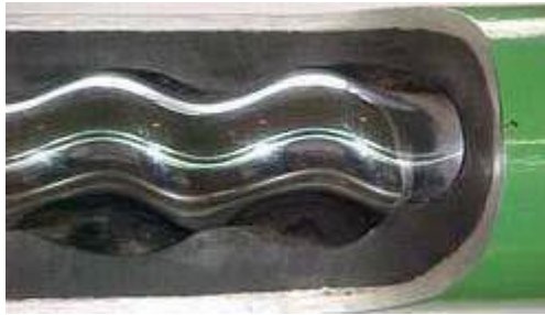
Figura 8. Vista interna de un rotor dentro de un estator (con su elastómero)
