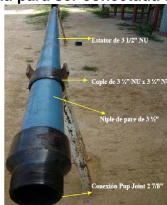
Figura 11. Bomba armada para ser conectada a la tubería de producción
