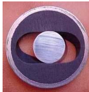
Figura 7. Sección transversal de un estator y un rotor
