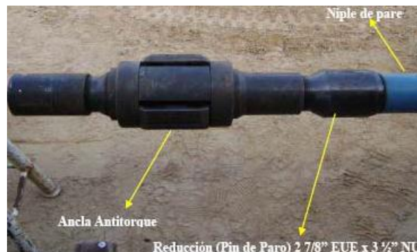
Figura 12. Ancla de torque instalada en el extremo de la Bomba
