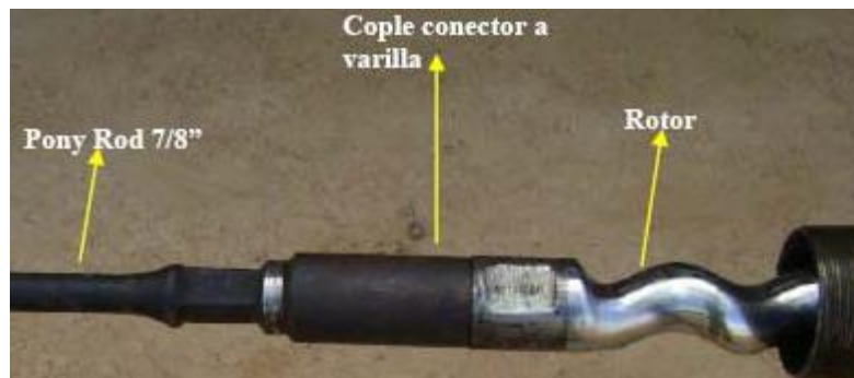
Figura 14. Vista de la Conexión de varillas con el rotor de la bomba
