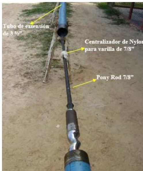
Figura 13. Vista del Rotor con el Pony Rod y el Centralizador de varilla respectivo
