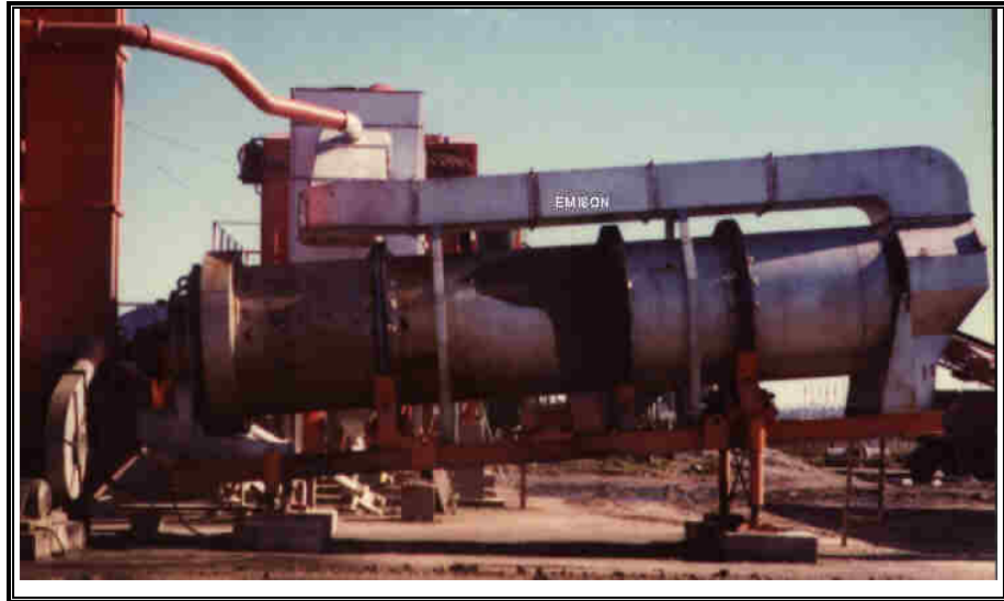
Figura 17. Secador rotatorio con aire caliente en contracorriente
