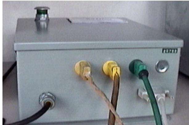
Figura 53. Conexiones correctas de los cables compensados en los tomas.
