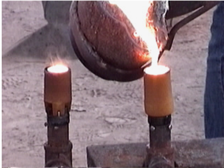
Figura 72. Obtención de las muestra para análisis
