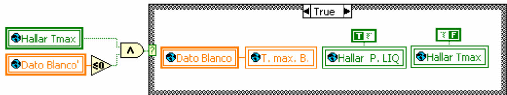
Figura 37. Programación en LabVIEW para capturar Tmáx.
