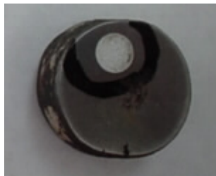
Figura 74. Muestra analizada por espectrometría de chispa (Sicolsa S.A.)
