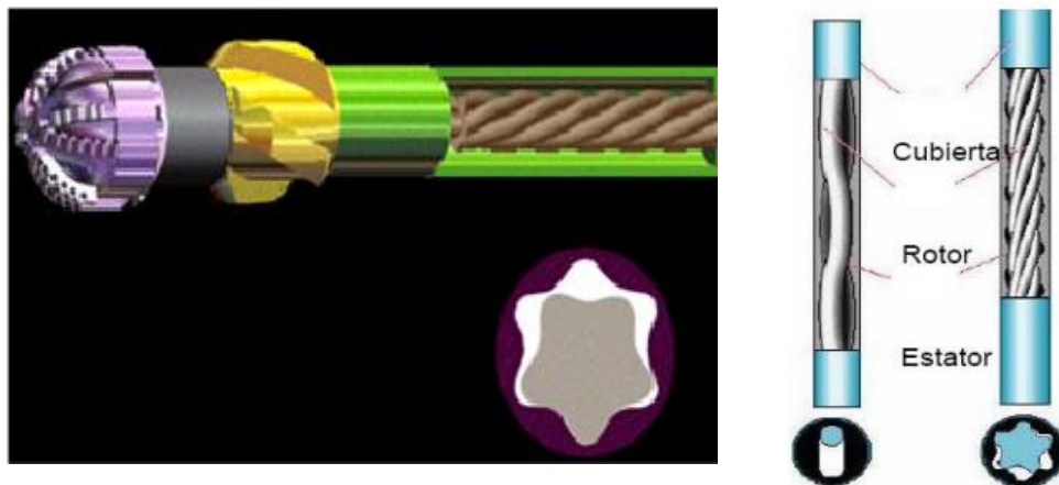
Figura 3. Motor de Fondo y sus principales Componentes
