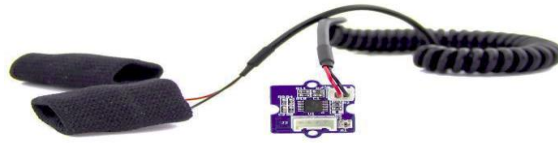
Figura 11. Sensor de respuesta galvánica de la piel.
