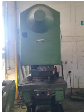
Figura 25. Troqueladora 8, potencia de 5500 watt
