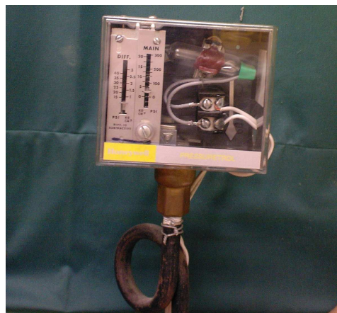
Figura 6. Switch On/Off de presión. Fuente: Autores.
