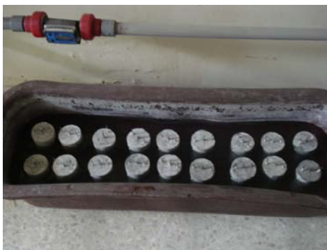
Figura 3. Probetas expuestas al ataque de sulfatos y cloruros.
