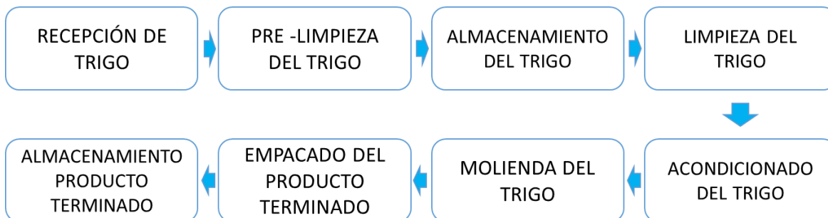
Figura 5. Diagrama de flujo general del proceso de producción
