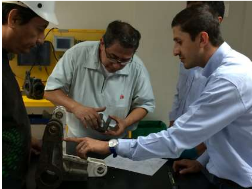
Figura 33. Análisis de falla del brazo-eje de la lavadora de la Línea 1
