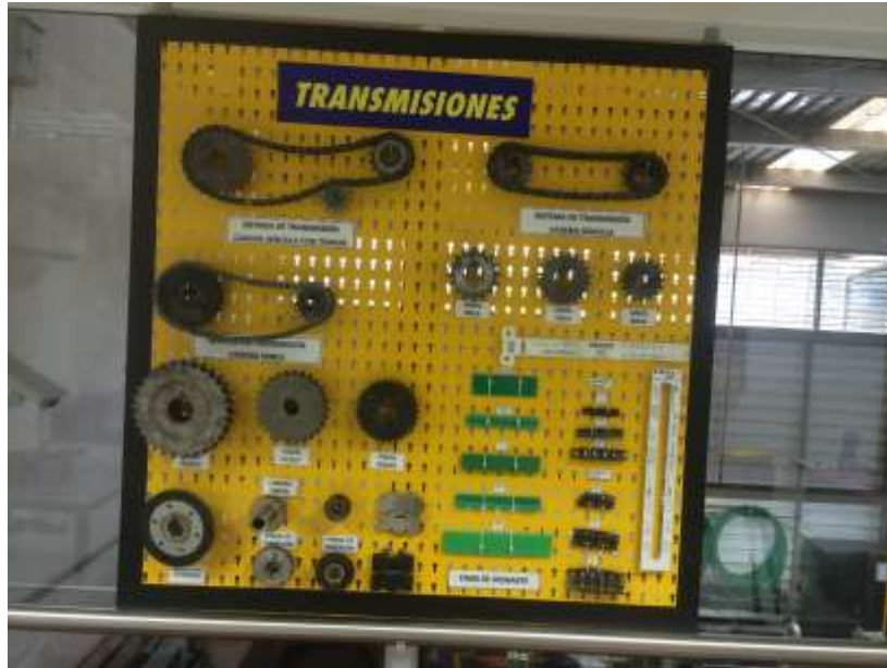
Figura 16. Tablero de transmisión
