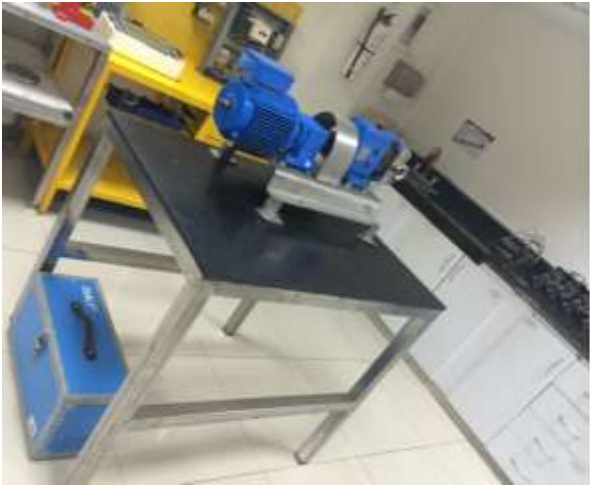
Figura 19. Modulo para el entrenamiento en alineación láser de motores.
