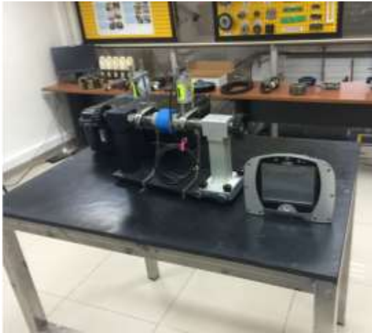
Figura 19. Modulo para el entrenamiento en alineación láser de motores.
