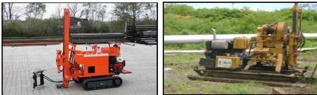
Foto 3. Barreno mecánico tipo oruga
