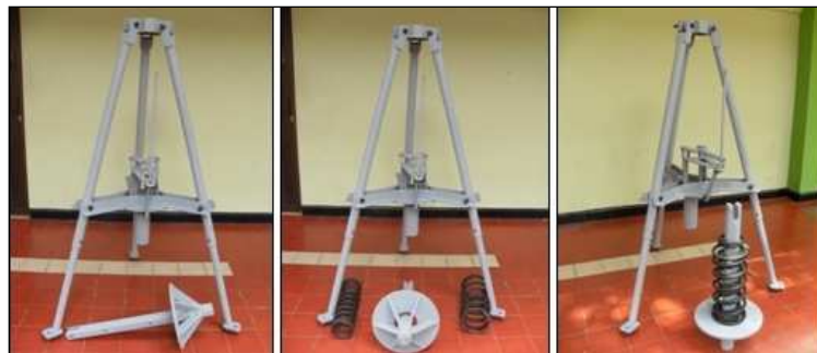
Figura 104. Resortes insertados en el martillo
