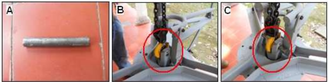
Figura 109. (a) Pasador 2510. (b) y (c) Pasador insertado en el martillo
