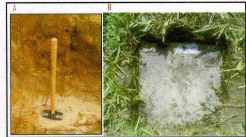
Figura 4. Elementos utilizados en el método tradicional de generación de ondas acústicas; (A) Porra, (B) Platina
