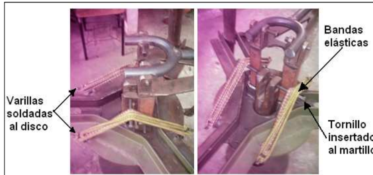
Figura 62. Montaje del martillo pre-tensionado
