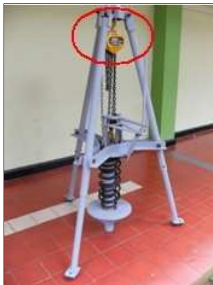
Figura 108. Diferencial ubicada en el equipo
