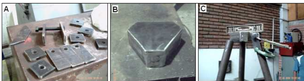
Figura 38. (a) Platinas de unión de patas y unión superior (b) Unión superior sin platinas soldadas (c) Ensamble entre patas y unión superior
