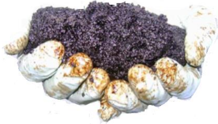
Figura 1 Muestra de parafina precipitada tomada en la tubería de un pozo.
