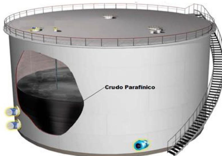
Figura 28 Acumulación de parafinas en tanque de almacenamiento
