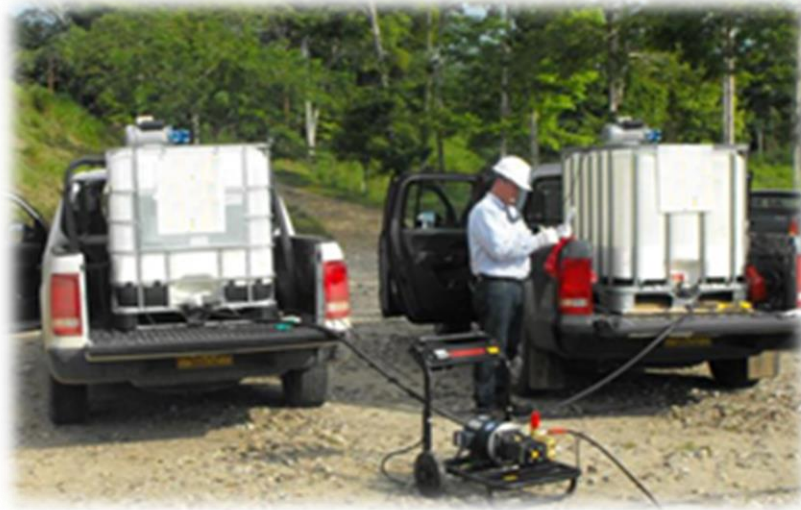
Figura 37 Remoción de parafinas por el método de tratamiento térmico
