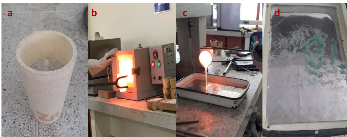
Figura A. Proceso de fabricación de la frita de vidrio de zinc.
