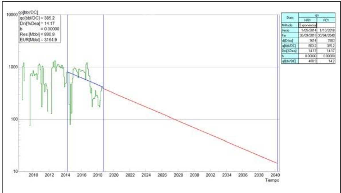
Gráfica 4. Declinación de un pozo mediante software Sahara.
