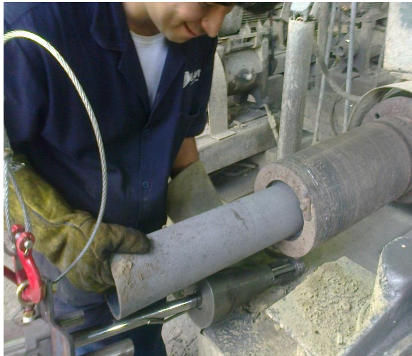
FIGURA 53. EXTRACCIÓN FINAL DE LA CAMISA
