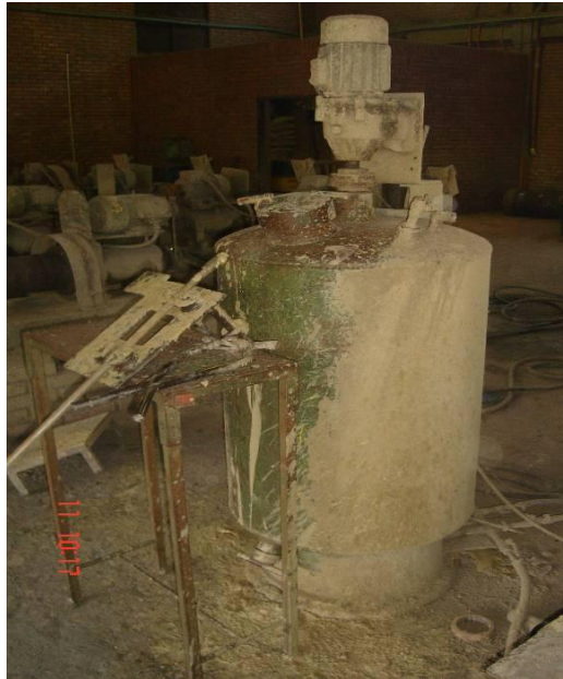
FIGURA 18. TANQUE MEZCLADOR DE PINTURA Y PISTOLA DE ROCIADO
