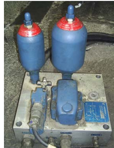
Figura 83. Circuito Hidráulico y fotografía del manifold de control
