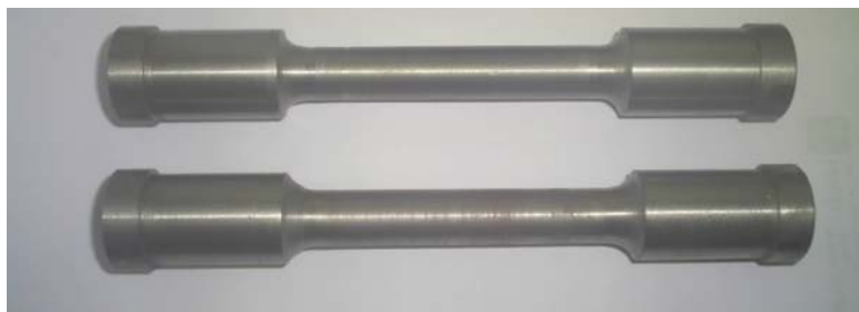
Figura 162. Imágenes prueba de Tensión.
