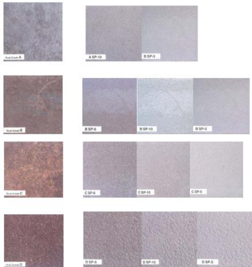
Figura 12. Muestras de distintos grados de preparación de superficie
