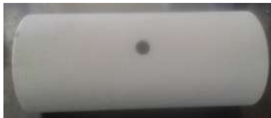
Figura 21. Tubería limpia - Grado metal blanco
