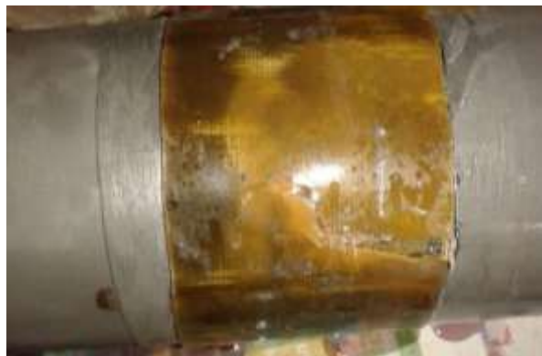
Figura 17. Daños en el material a una presión de 450 psi y una temperatura de 90 °C
