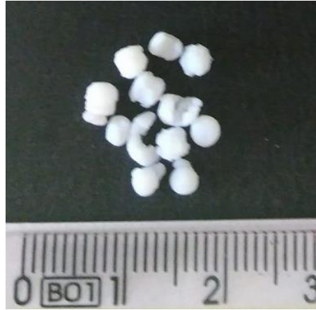
Figura 9 - Defectos en los monolitos esféricos.
