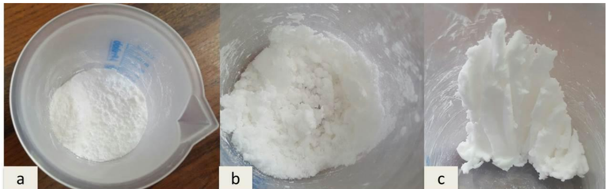
Figura 3 - Proceso de mezcla, a) Mezcla de sólidos, b) Mezcla con el agua como líquido aglutinante, c) Masa homogénea.
