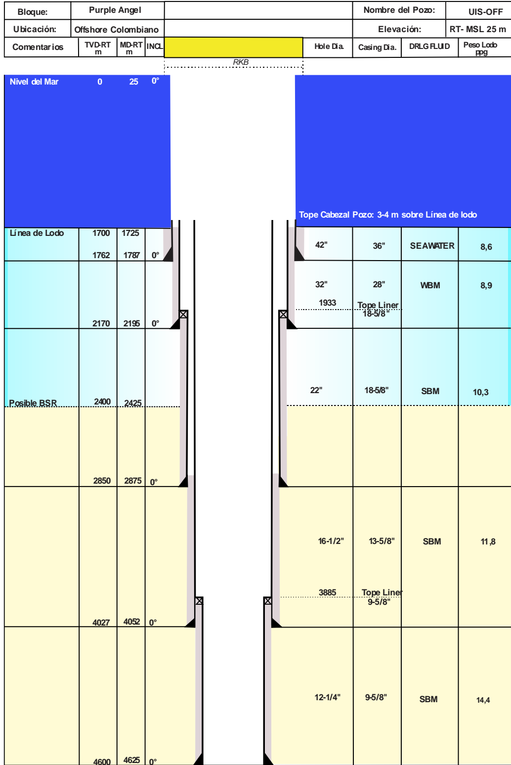
Figura 36. Estado mecánico del pozo UIS-OFF.
