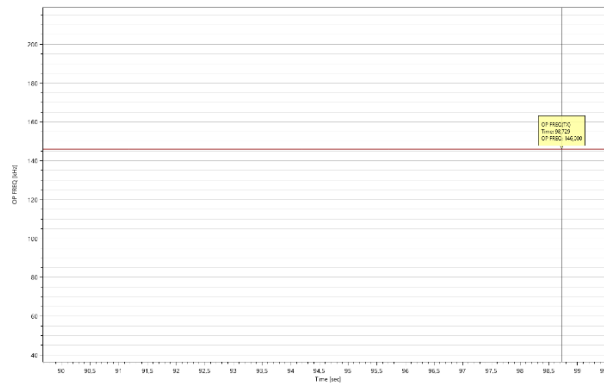
Figura C-17. Frecuencia de operación de la STEVAL sin carga.
