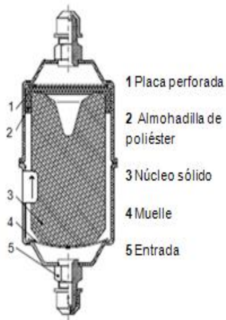
Figura 33. Detalles del Filtro deshidratador Danffos.
