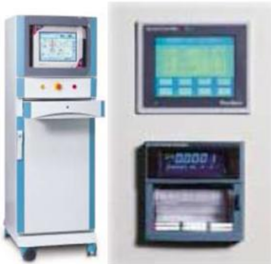
Figura 16. Fotografía de un banco de control de un liofilizador piloto.
