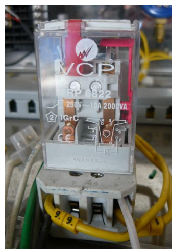
Figura 96. Relevos VCP de 8 pines a 220 V (Relés R1, R2 y R3).
