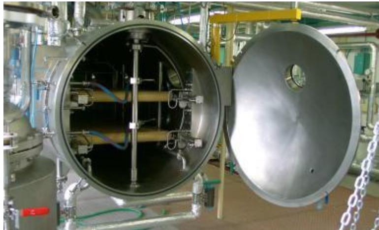
Figura 17. Instalación industrial de un liofilizador continuo con el producto sobre cintas
