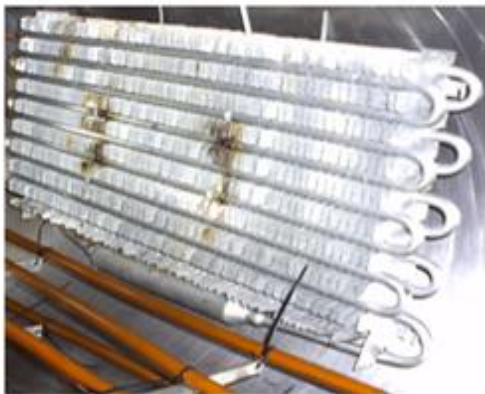
Figura 102. Evaporador JORVAN montado en la cámara de trabajo.
