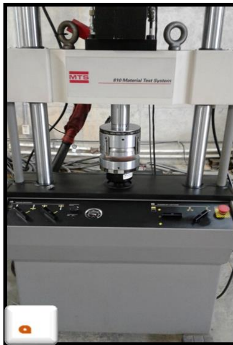
Figura 10. Muestras sometidas a compresión y equipo usado. a) Máquina universal de ensayos MTS 810; b) ensayo de compresión en probeta.
