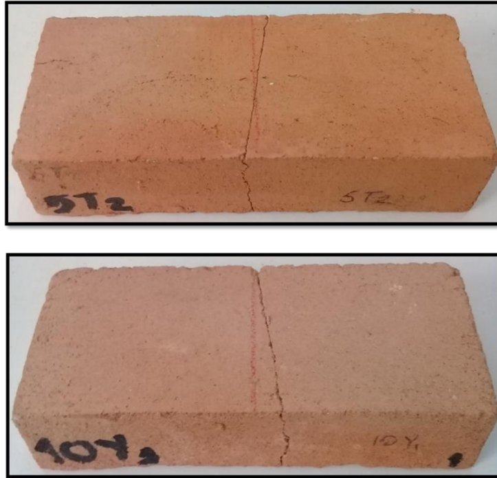
Figura 30. muestras después de ensayo de flexión
