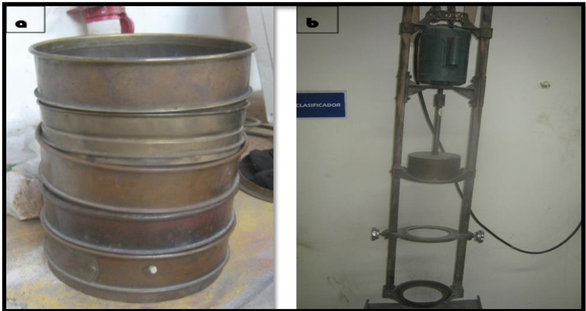
Figura 5. Equipo de Tamizaje: a) Tamices 20, 30, 60, 80 y 100. B) Tamizadora de la planta de aceros Univeridad Industrial de Santader - UIS.
