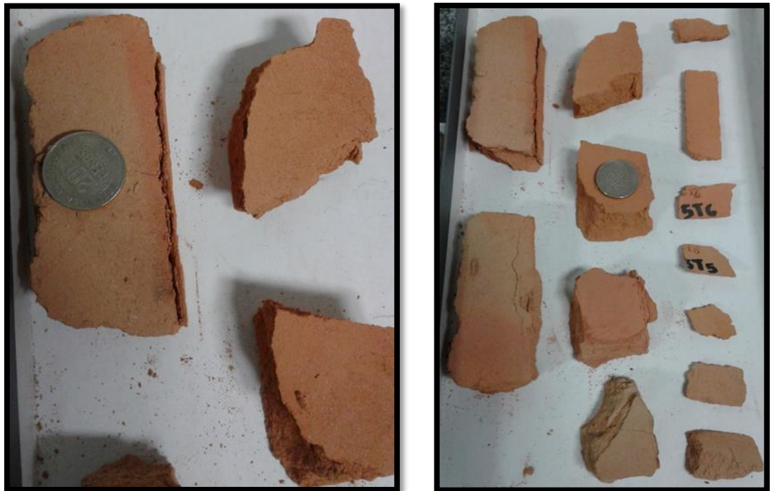
Figura 27. Fragmentos de probetas después del ensayo de compresión.
