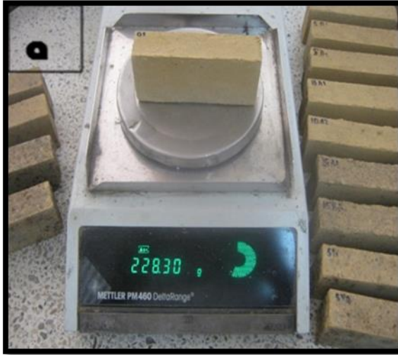
Figura 9. Fase de pesado y cocción de probetas a) probetas de ladrillo pesadas antes de hornear b) acomodación de probetas y mufla utilizada; c) proceso de cocción, mufla a 800°C; d) muestras después de hornear
