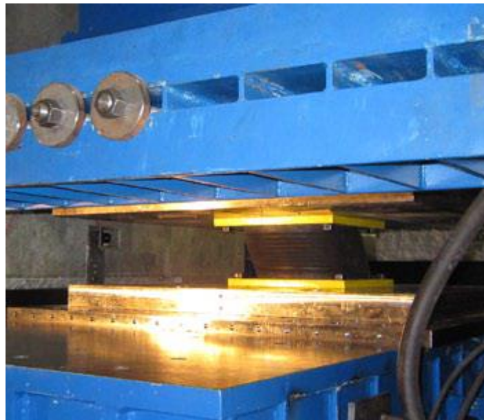
Figura 9. Aislador con Núcleo de Plomo LASTO®LRB
