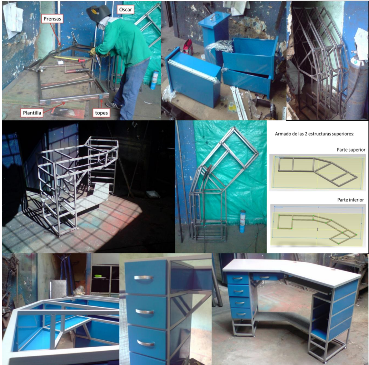
Figura 77: Fabricación del Puesto de control
