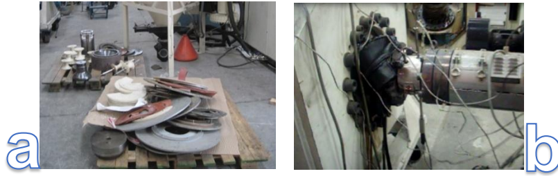
Figura 33: a) Accesorios línea E1, -b) Fuga de Material en Extrusora
