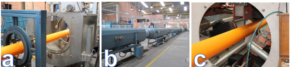
Figura 24: a) Ultrasonido y Corrector de Ovalamiento, -b) Tanques de Refrigeración, -c) Halador
