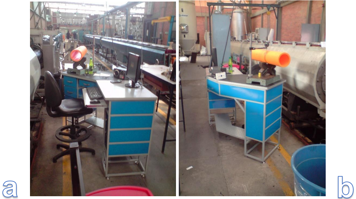
Figura 80: Puesto de control con medidor de ovalamiento
