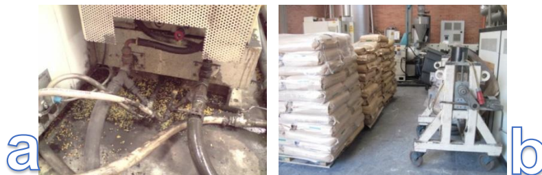
Figura 32: a) Humedad por acumulación de Pellets, -b) Acumulación de estivas con materia prima
