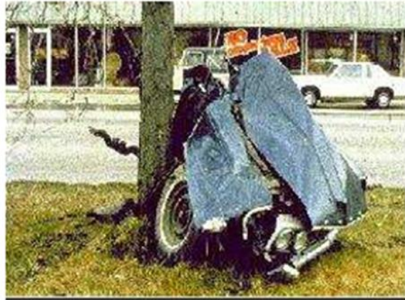
Figura 42. Árboles dentro de la Zona Lateral. Adaptado de Manual para el Tratamiento de Zonas Laterales de Zonas Laterales en Carreteras Colombianas.
